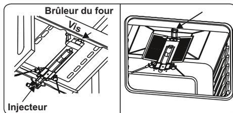
Démonter les injecteurs à l'aide d'une clé de 7 mm et les remplacer par ceux du jeu de rechange. S'assurer d'utiliser les diamètres correspondants adaptés au type de gaz qui sera utilisé, conformément au tableau d'information (également fourni dans le kit de conversion de gaz).
